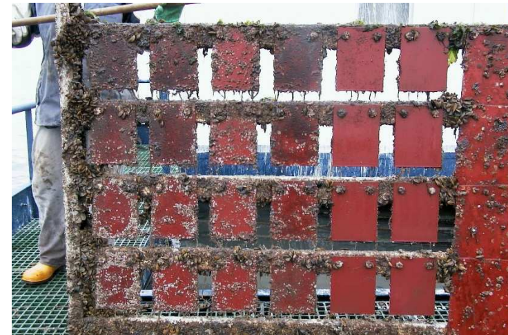
Antifouling coatings met verschillend biocide gehalte
